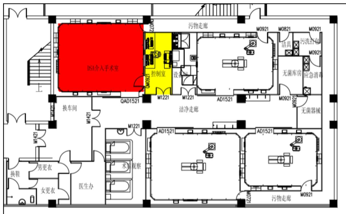
图 10-1 本项目射线装置机房两区划分示意图（红色为控制区，黄色为监督区）
